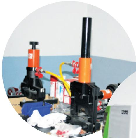
**Máquinas corte de calhas**
